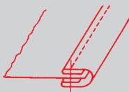
Für Einfaßarbeiten, beide Kanten eingeschlagen, 90° Bandzuführung, Apparat auf abschwenkbaren Träger befestigt.
