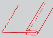
Für Einfaßarbeiten, 90° Bandzuführung, Apparat auf abschwenkbarem Träger befestigt.
