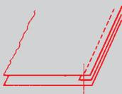
Einnähen eines Paspels zwischen 2 Materiallagen, Paspelführung abschwügelig, Apparat feststehend. Erhältlich in N 2,5 (Stichlänge max. 2,5 mm) oder für max. 4,5 mm Stichlänge.
